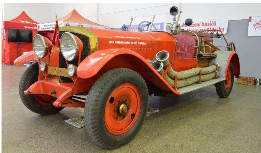
Automobilová stříkačka NW na podvozku Nesselsdorf U, později vyráběný jako Tatra 10
